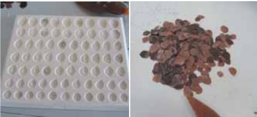
Vakuumbord til fremstilling af fiskeskæl, og de færdig udklippede skæl, klar til montage på Latimaria
